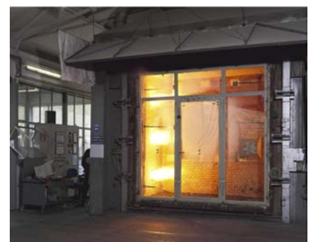
Figuur 7.1: Start brandproef van een enkele deur met twee zijlichten en een bovenlicht.
